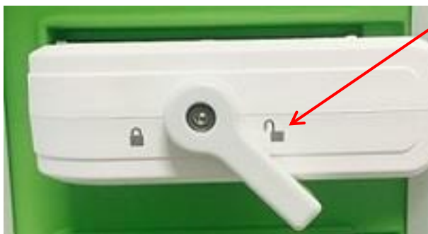
11. ábra: A transzducercsatlakozó rögzítőgombja kioldva
