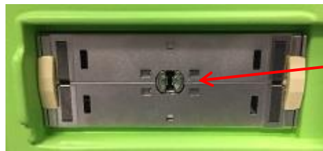
9. ábra: A transzducer-csatlakozóaljzaton lévő reteszelőnyílás
